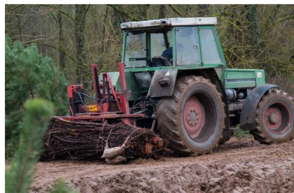
Auf maschinelle Hilfe von Bagger und Trecker kann verzichtet werden, wenn die Bündel entsprechend handlich gestaltet werden.
